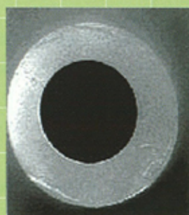
中空糸膜断面 (外径φ1.4mm/内径φ0.8mm)
