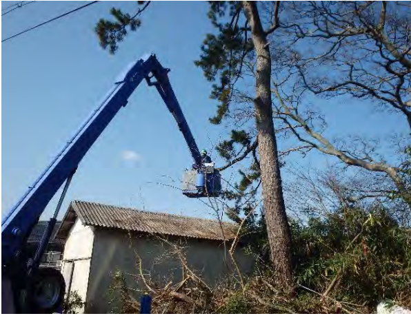
クレーンを用いた高所伐採（枝伐り）
